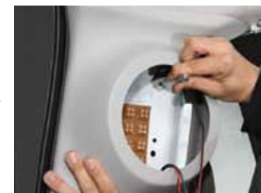
Dピラーカバーを仮止めし、固定穴の位置をボンチします。
