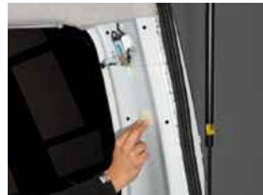
付属の下処理清浄シートで貼付面を清浄します。
