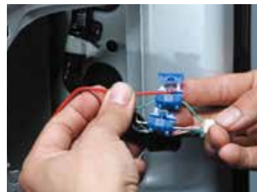
付属のエレタップを使い、LEDテープ接続ケーブルの赤を車両側の緑色（銀の縞）の線に、黒を車両側の黒のライン入りの白（銀の縞）線に接続します。
