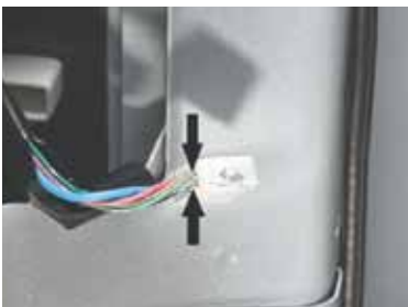
付属のエレタップを使い、LEDテープ接続ケーブルの赤を車両側の緑色（銀の縞）の線に、黒を車両側の黒のライン入りの白（銀の縞）線に接続します。
