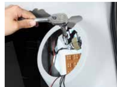
取り外したボルトを使って、アンテナカブラーブラケットとDピラーカバーを一緒に固定します。
